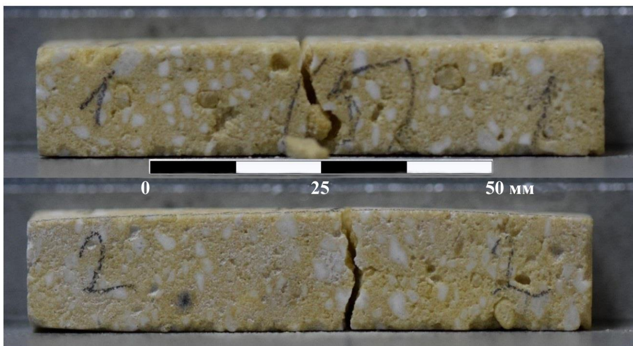
Рисунок 46. Траектория трещины при разрушении образца огнеупора при испытании на предел прочности при изгибе. Фото Буяков А.С. –ИФПМ СО РАН.
