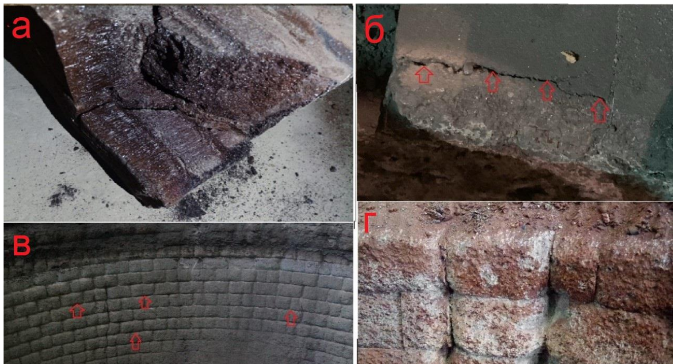
Рисунок 63. Виды трещин в огнеупорах. (а) – V-образные трещины, (б) – параллельные рабочей грани, (в) – радиальные, перпендикулярно рабочей грани, (г) – выкрашивание и размытие углов рабочей грани при комплексной нагрузке.
