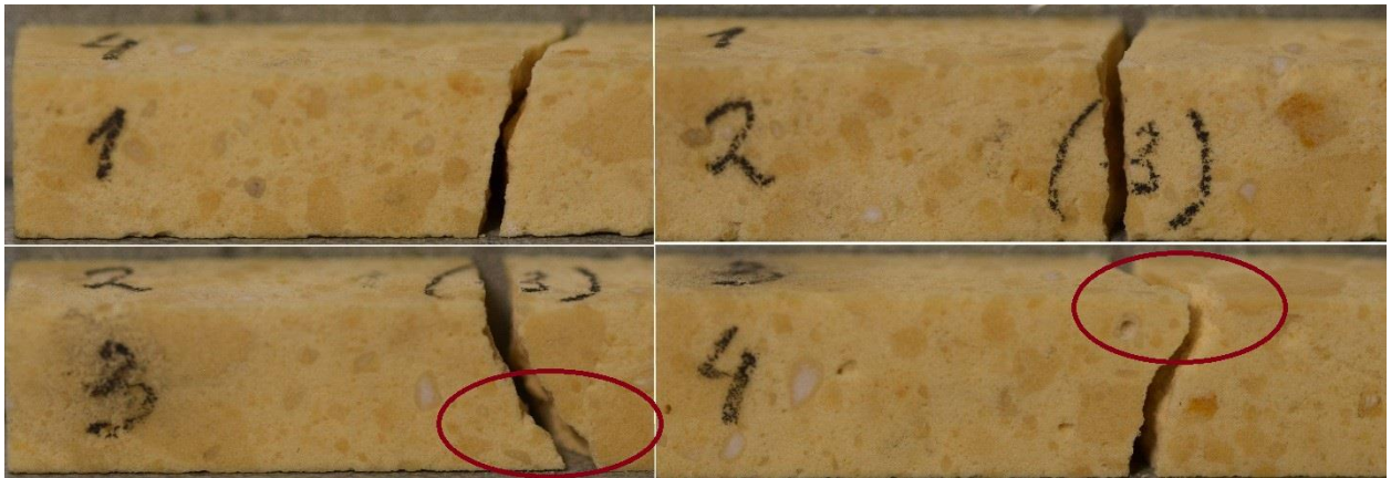
Рисунок 26. Направление движения трещины по разным поверхностям образца при трехточечном изгибе. Центральный пуансон действовал на плоскость 1. Фото Буяков А.С., ИФПМ СО РАН.
