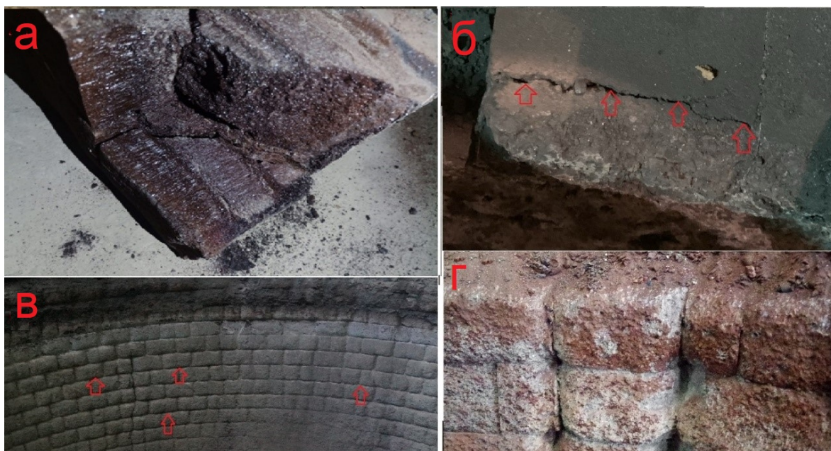
Рисунок 10. Виды трещин в огнеупорах. (а) – V-образные трещины, (б) – параллельные рабочей грани, (в) – радиальные, перпендикулярно рабочей грани, (г) – выкрашивание и размытие углов рабочей грани при комплексной нагрузке.
