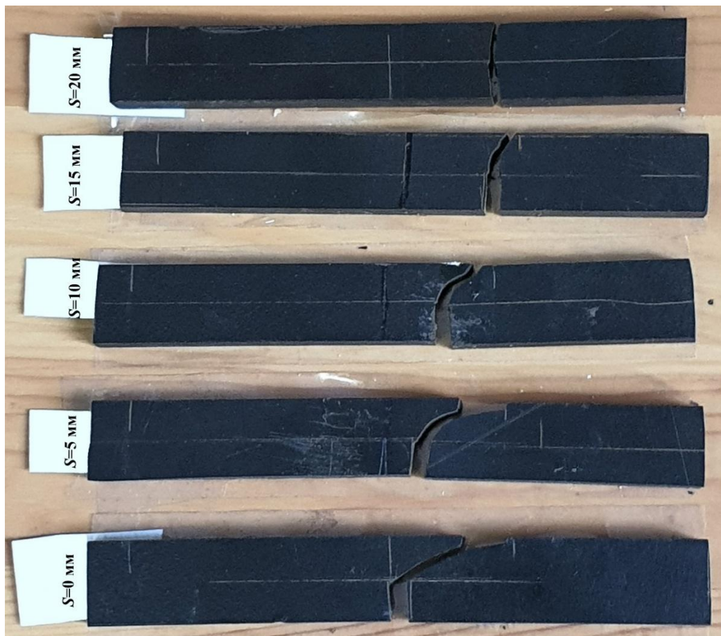
Рисунок 3.7 — Разрушенные образцы из эбонита
