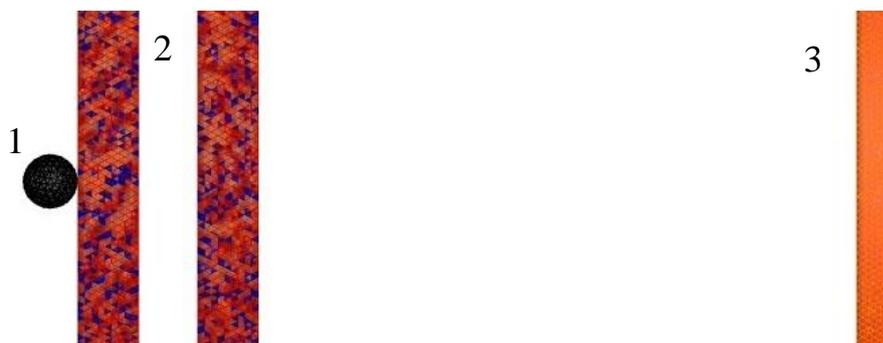
Рисунок 55 – Геометрическая модель с гетерогенными пластинами: 1 – сфера из стали ШХ15; 2 – пластины из смеси (АМг6 +  $V_4C$ ); 3 – пластина из стали 10
