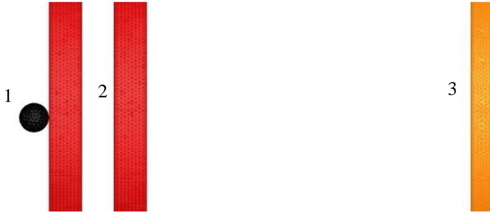
Рисунок 53 – Геометрическая модель: 1 – сфера из стали ШХ15; 2 – пластины из сплава АМгб; 3 – пластина из стали 10
