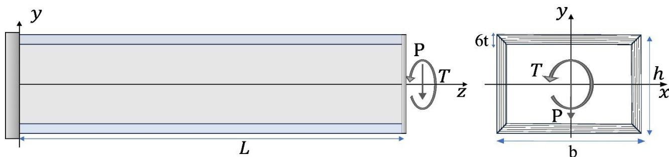
Рисунок 3.5. Схема кручения и изгиба коробчатого композитного стержня
