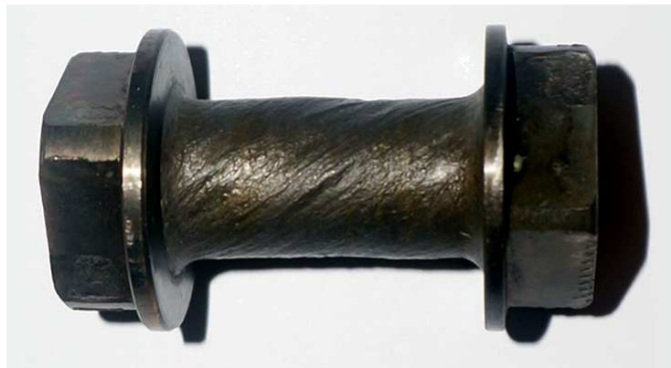
Рисунок 2.5 – Образец из сплава Ti-Al-Sn-V, вырезанный в продольном направлении из плиты толщиной 60 мм, после кручения постоянным моментом при температуре T=700\text{ }^{\circ}\text{C}
