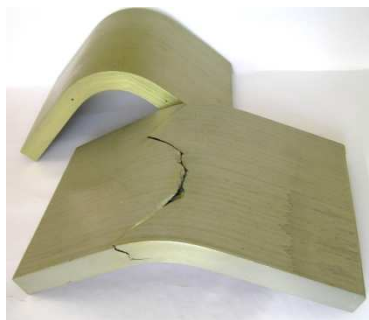
Рисунок 1.1 – Изгиб пластины из алюминиевой танковой брони марки АБТ-102 толщиной 24 мм при комнатной температуре (на переднем плане) и при температуре закалки 470°С (на втором плане)
