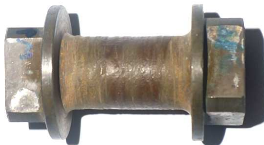
Рисунок 2.3 – Образец из сплава Ti-Al-Sn-V, вырезанный в направлении нормали из плиты толщиной 60 мм, после кручения постоянным моментом при температуре T = 700 \text{ }^{\circ}\text{C}
