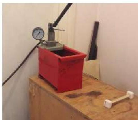
Рис. 5.5 Испытания на стойкость к внутреннему давлению АПТ при  $T=-15^{\circ}\text{C}$
