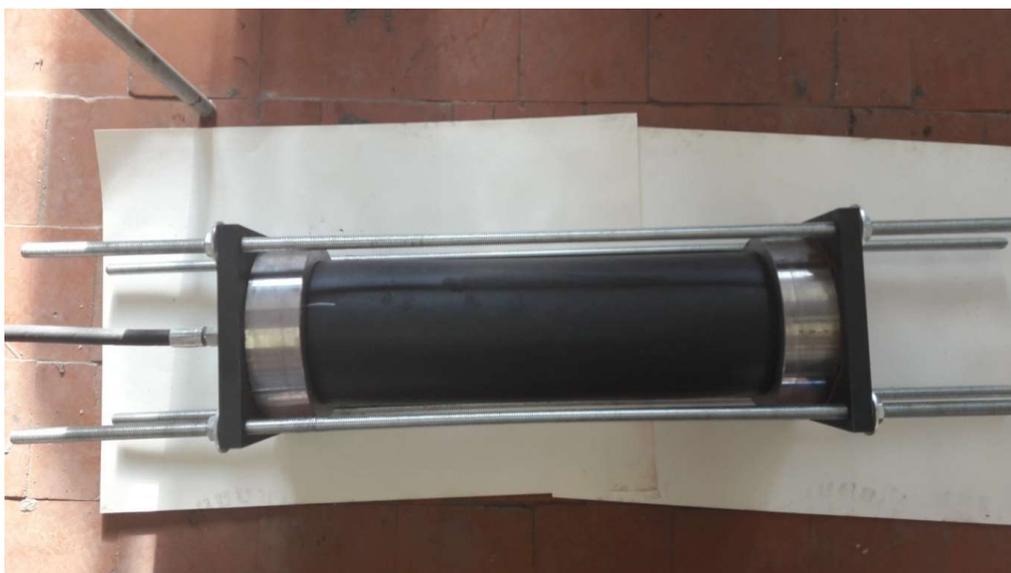
Рис. 5.3 Внешний вид образца-свидетеля АПТ в заглушках, при испытании на стойкость при постоянном внутреннем давлении
