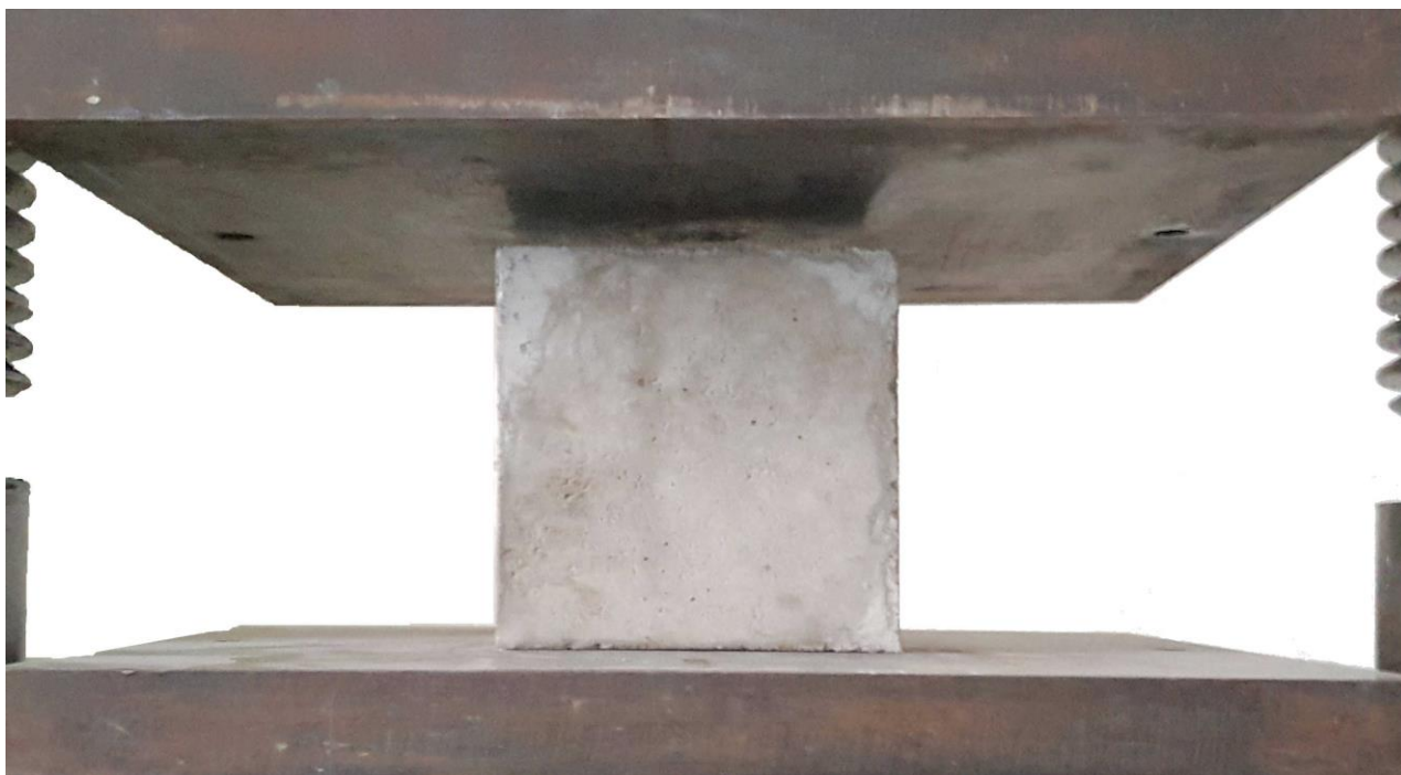
Рис. 2.10. Вид установленного на испытательном прессе куба 150×150×150 мм
