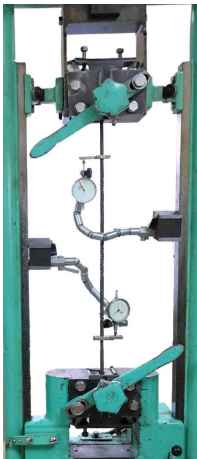
Рис. 2.8. Вид образца из арматурной стали, установленного на испытательную машину
