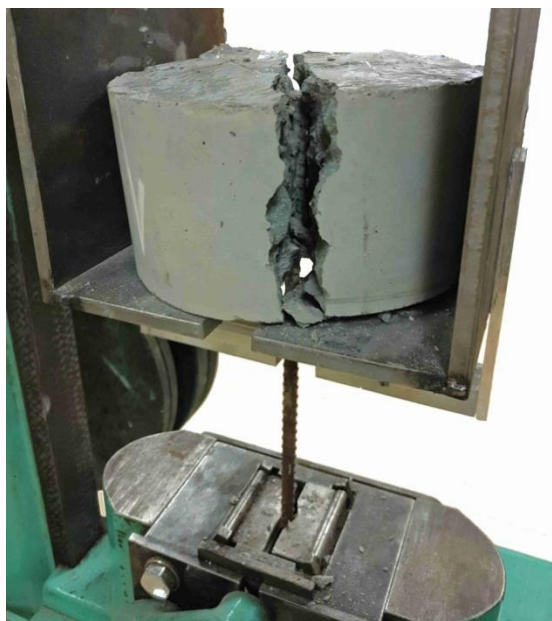
Рис. 2.15. Вид расколовшегося короткого образца
