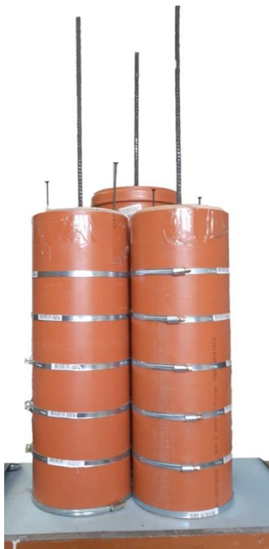
Рис. 2.3. Вид готовой опалубки длиной 470 мм
