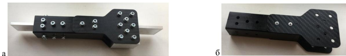
Рис. 13. Испытательные образцы болтового (а) и клеевого (б) соединений
