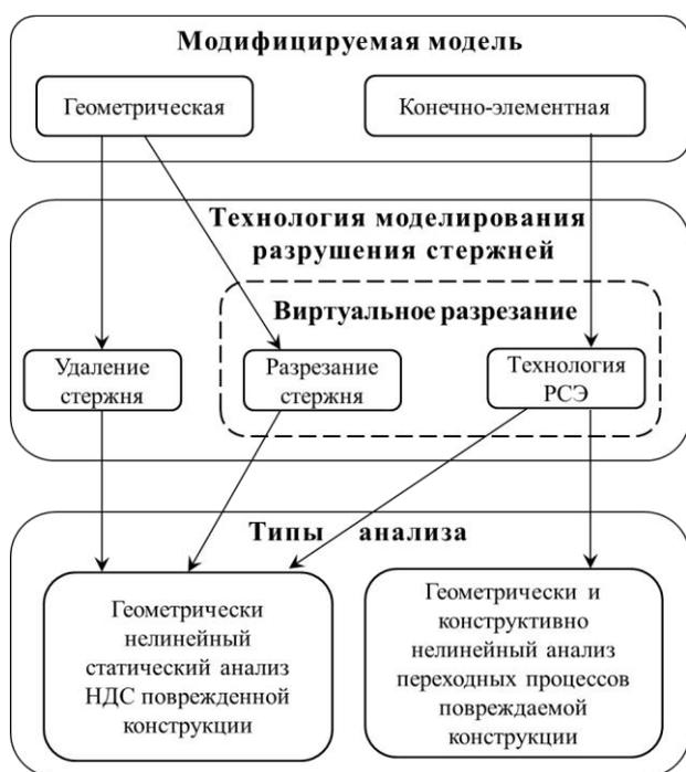
Рис. 1. Взаимосвязь технологий моделирования разрушения стержней и анализа НДС конструкций
