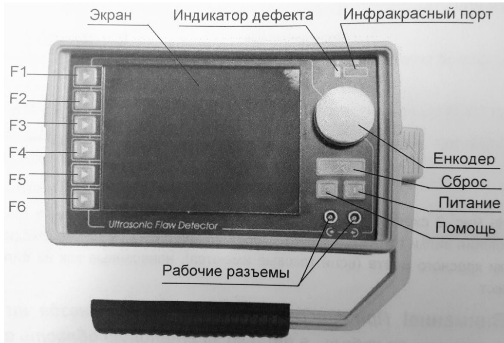
Рис. 4.5. Фронтальная панель ультразвукового дефектоскопа
