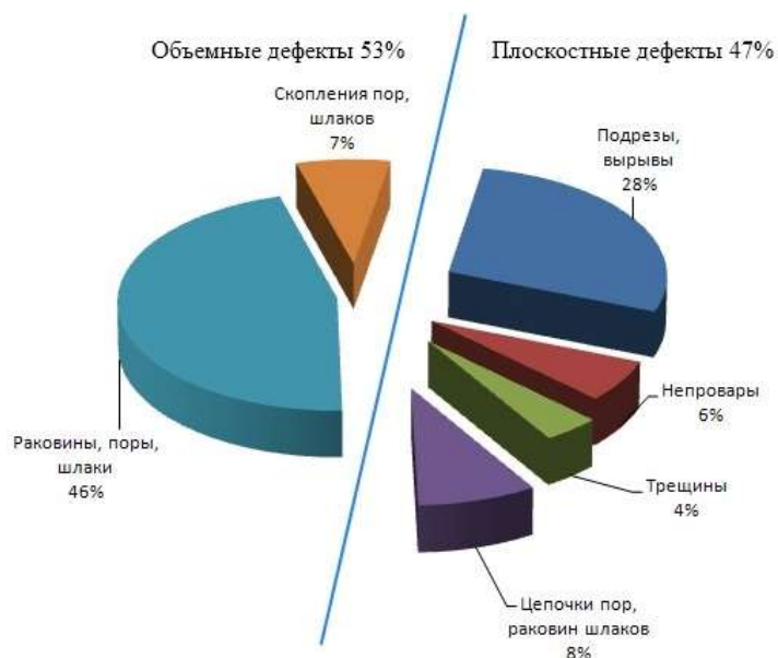
Рис. 3.12. Распределение дефектов сварных соединений резервуаров по принципу плоскостные и объемные
