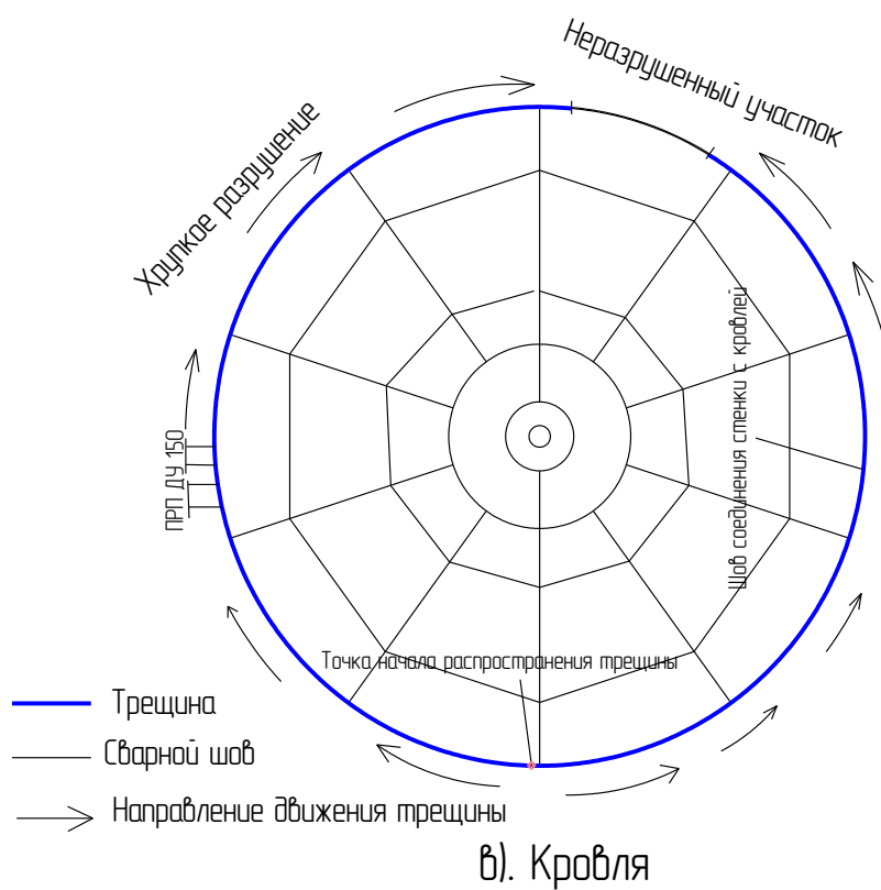
Рис. 2.21. Схема разрушения резервуара РВС-700 №49, вид сверху
