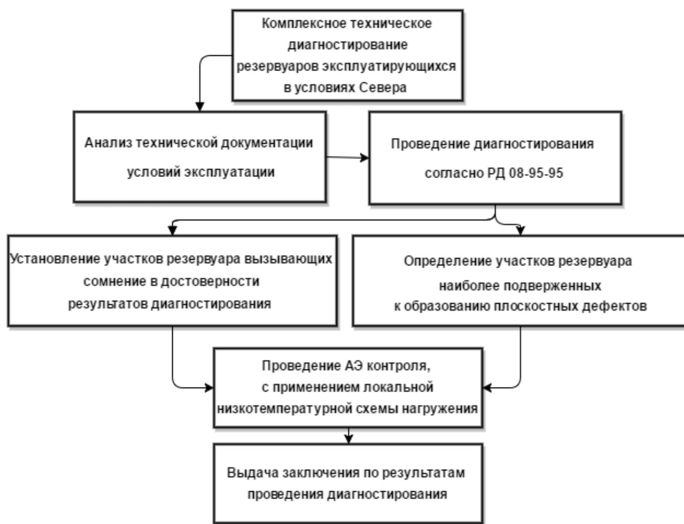
Рисунок 11 – Комплексное техническое диагностирование резервуаров с дополнительным локальным АЭ контролем
